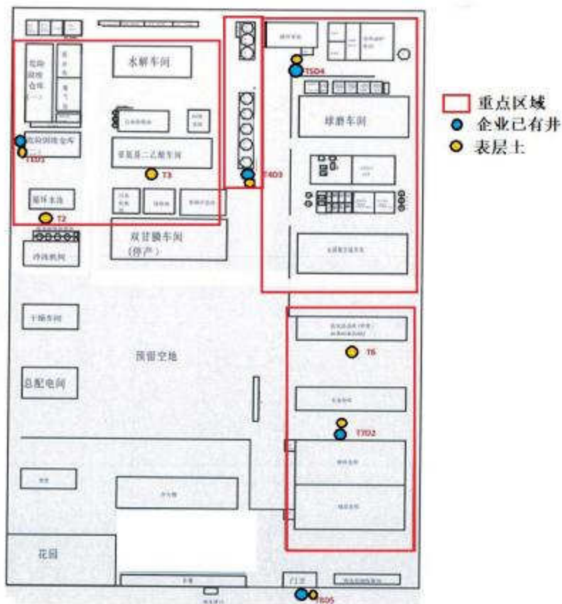
图6.1-1 土壤和地下水布点图
