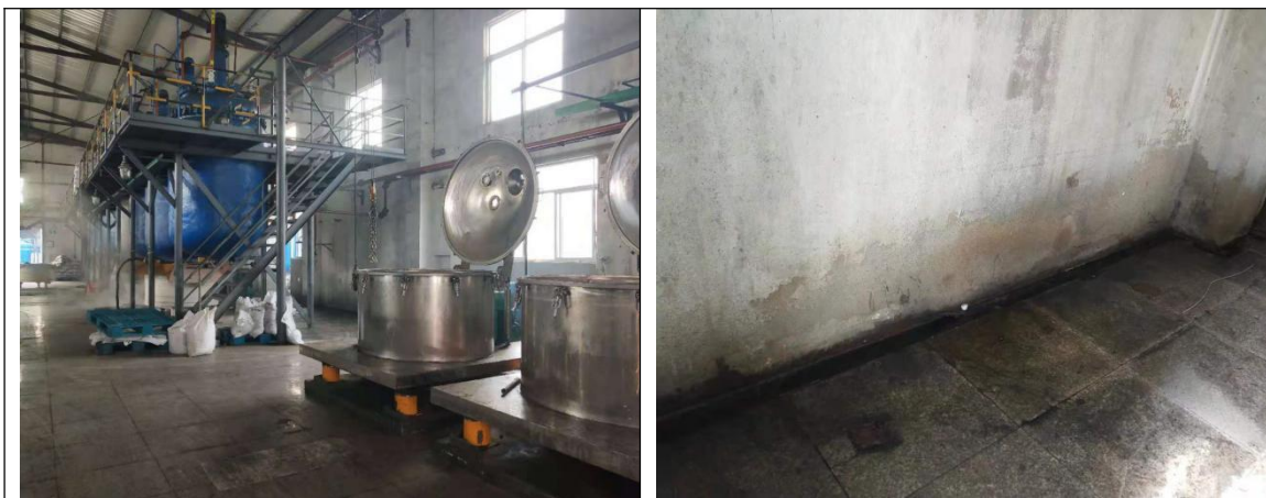
三车间：二乙酸和盐酸、亚磷酸、甲醛缩合反应生产双甘膦，车间内地面均已硬化，无明显破损，现已停用。
